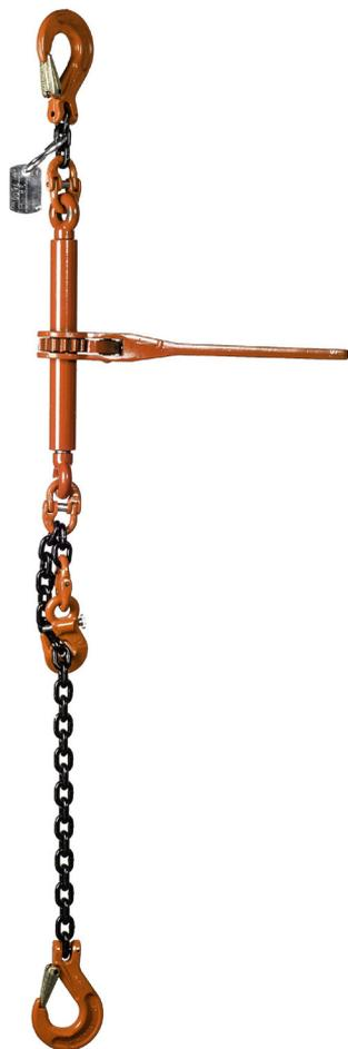
Les chaînes d'arrimages sont conçues pour arrimer les charges lourdes en toute sécurité pendant le transport routier, par avion et sur mer. Ils sont livrés avec tendeur à cliquet, crochet à linguet et crochet de réglage avec une axe de sécurité ce qui évite le détachement en tremblant des chaînes suite à une chute de tension provoquée pendant le transport. À l'aide du cliquet fourni, les chaînes d'arrimages peuvent être tendus d'une manière contrôlée.
